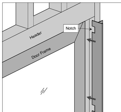
Fig. 2. Notch extension jamb
